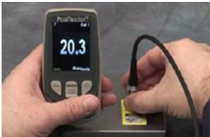
Para la inspección de medición de espesor de los materiales mediante el método de contacto impulso-eco, se debe realizar a temperaturas que no excedan de 93 °C (200 °F).
